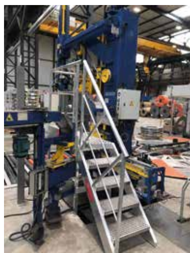
• Escalier d'accès machine
