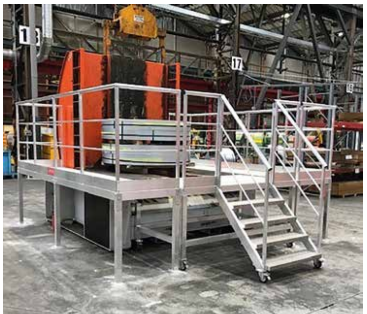
• Plateforme d'entretien industriel
