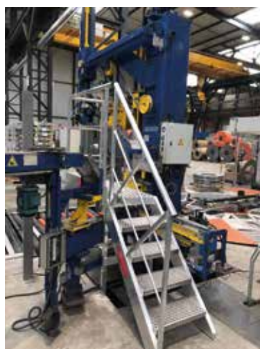
• Escalier d'accès machine
