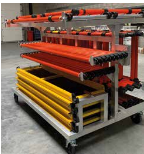
• Rack de transport échafaudage
